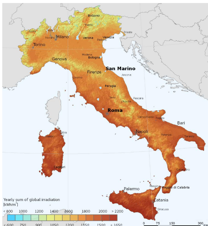
Figura 10-Irraggiamento solare annuo Italia - PVGIS 2001-2012
