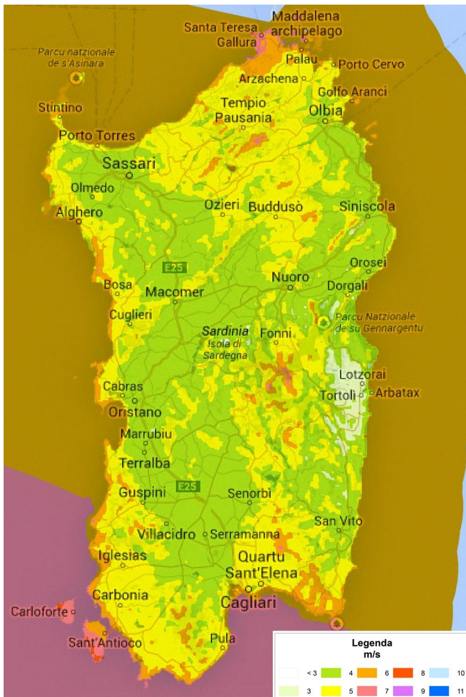
Figura 11-Velocità media annuale del vento a 25 m slt
